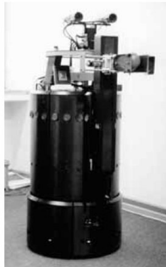
Рис. 9.12 Мобильный робот для работы в помещениях типа RWI B21, оснащённый 24 ультразвуковыми датчиками, смонтированными в круговой массив на корпусе робота.
