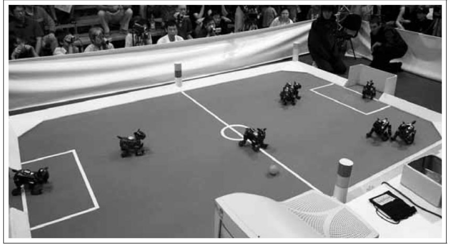
Рис. 7.7 Роботы AIBO на футбольном поле RoboCup. По углам поля и на центральной линии расположены шесть ориентиров.
