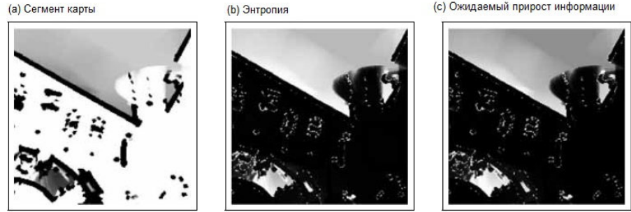
Рис. 17.6 Карта, энтропия и ожидаемый прирост информации. На рисунке показано соответствующее масштабирование, энтропия и ожидаемый прирост информации почти неразличимы.
