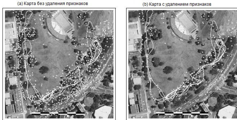
Рис. 13.11 FastSLAM 1.0 (a) без удаления признаков (b) с удалением признаков на основе отрицательной информации.
