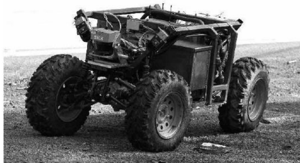
Рис. 11.4 Робот «Groundhog» («Сурок») - 640 килограммовый самоходный робот, оборудованный бортовым компьютером, лазерными датчиками расстояния, датчиками газа и воды, а также системой видеофиксации. Робот был построен для картографирования заброшенных шахт)
