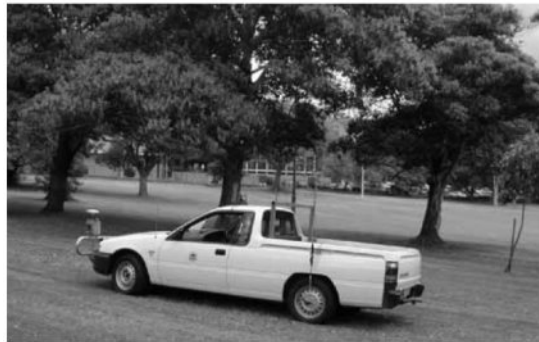
Рис. 12.13 Автомобиль, используемый в экспериментах, оборудован двухмерным лазерным дальномером и дифференциальной системой GPS. Собственное движение автомобиля измеряется датчиком линейного дифференциального преобразования для угла поворота колес, и энкодером измерения скорости на колесе. На заднем плане видна территория парка Виктория, используемая как среда для тестирования. Изображение принадлежит Хосе Гюванту и Эдуардо Неботу из Австралийского центра полевой робототехники (José Guivant and Eduardo Nebot, Australian Centre for Field Robotics).
