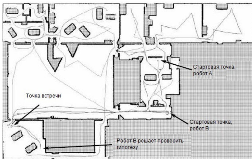
Рис. 17.14 Координированное исследование при неизвестных начальных положениях. Роботы устанавливают общую систему отсчёта, оценивая и проверяя относительное положение друг друга с помощью метода рандеву. При встрече они обмениваются картами и координатами исследований. Собственность Джонатана Ко и Бенсона Лимкеткай (Jonathan Ko and Benson Limketkai).
